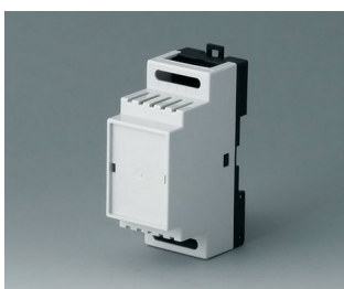
B6501114 RAILTEC B, 2 Module, Ausf. I PC (UL 94 V-0) lichtgrau RAL 7035 35x86x58mm
