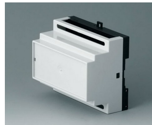
B6504111 RAILTEC B, 6 Module, Ausf. I PC (UL 94 V-0) lichtgrau RAL 7035 105x86x59mm
