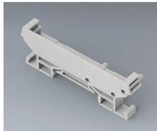
B6724335 RAILTEC SUP. 72, Endstück mit Fuß PA 6 (30) (UL 94 V-0) lichtgrau 82x11,2x22,5mm
