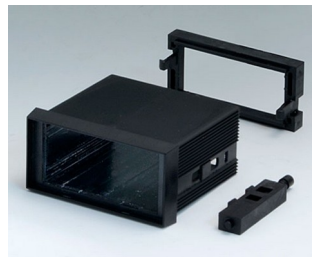
B6021011 NORM-EINBAUGEHÄUSE TYP A PPO (UL 94 V-0) schwarz RAL 9005 72x36x57mm
