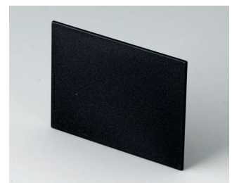
B6132222 Rückplatte PPO (UL 94 V-0) schwarz RAL 9005 63,8x49,2x1,7mm
