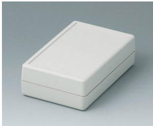
A9406351 SCHALLENGEHÄUSE G 110, Ausf. I ABS (UL 94 HB) grauweiß RAL 9002 72x114x33,5mm IP 65 opt.
