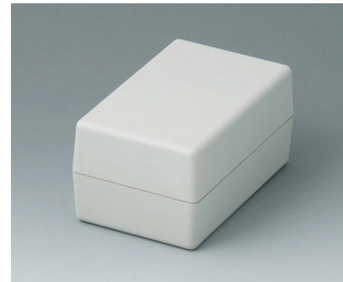
A9406441 SCHALLENGEHÄUSE G 110, Ausf. I ABS (UL 94 HB) grauweiß RAL 9002 72x114x57mm IP 65 opt.
