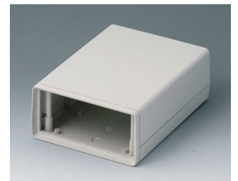
A9413340 SCHALENGEHÄUSE O 190, Ausf. I ABS (UL 94 HB) grauweiß RAL 9002 138x190x68mm
