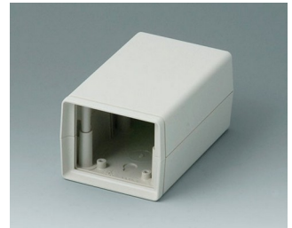
A9406443 SCHALLENGEHÄUSE V 110, Ausf. I ABS (UL 94 HB) grauweiß RAL 9002 72x114x57mm
