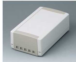
B1070465 TOPTEC 194 H, Ausf. II ABS (UL 94 HB) grauweiß RAL 9002 194x115x68mm IP 40
