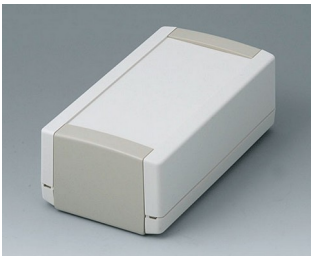
B1060365 TOPTEC 154 H, Ausf. I ABS (UL 94 HB) grauweiß RAL 9002 154x84x56mm IP 40
