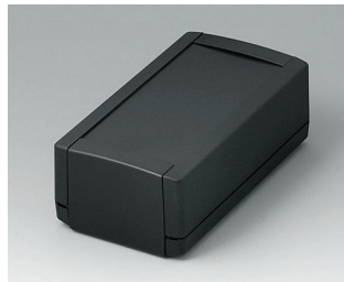
B1060369 TOPTEC 154 H, Ausf. I ABS (UL 94 HB) schwarz RAL 9005 154x84x56mm IP 40
