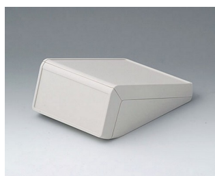
B4054117 UNITEC S, 1,4/1,4 ABS (UL 94 HB) grauweiß RAL 9002 125x177x69mm IP 40
