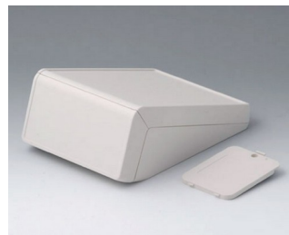
B4056237 UNITEC M, 0,6/1,4 ABS (UL 94 HB) grauweiß RAL 9002 148x210x80mm IP 40
