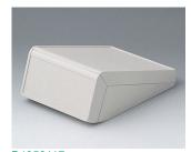
B4056117 UNITEC M, 1,4/1,4 ABS (UL 94 HB) grauweiß RAL 9002 148x210x80mm IP 40
