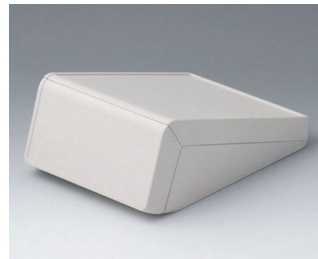
B4056137 UNITEC M, 0,6/1,4 ABS (UL 94 HB) grauweiß RAL 9002 148x210x80mm IP 40
