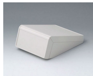
B4054127 UNITEC S, 1,4/0,6 ABS (UL 94 HB) grauweiß RAL 9002 125x177x69mm IP 40
