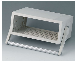
B2211317 MEDITEC D 160, mit Griffbügel ABS (UL 94 HB) grauweiß RAL 9002 290x200x124mm IP 40
