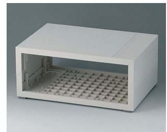
B2211207 MEDITEC D 160, ohne Griffbügel ABS (UL 94 HB) grauweiß RAL 9002 290x200x124mm IP 40
