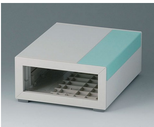
B2213015 MEDITEC E 160, ohne Griffbügel ABS (UL 94 HB) grauweiß RAL 9002 160x200x74mm IP 40
