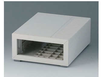
B2213007 MEDITEC E 160, ohne Griffbügel ABS (UL 94 HB) grauweiß RAL 9002 160x200x74mm IP 40
