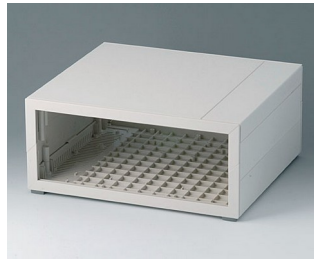
B2210217 MEDITEC D 220, ohne Griffbügel ABS (UL 94 HB) grauweiß RAL 9002 290x260x124mm IP 40
