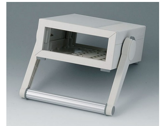
B2213107 MEDITEC E 160, mit Griffbügel ABS (UL 94 HB) grauweiß RAL 9002 160x200x74mm IP 40
