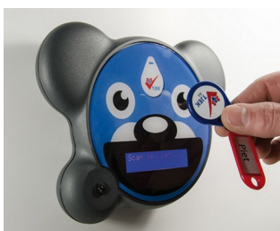
Zugangssteuerung für Kindergärten
