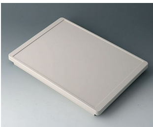
B4046407 Oberteil L ABS (UL 94 HB) grauweiß RAL 9002 275x195x25,5mm
