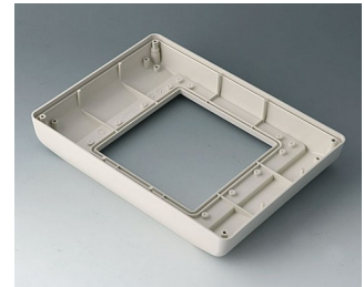
B4044757 Unterteil M hoch, Ausf. I ABS (UL 94 HB) grauweiß RAL 9002 225x165x35,5mm IP 54 opt.
