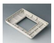
B4042707 Unterteil S flach, Ausf. I ABS (UL 94 HB) grauweiß RAL 9002 190x135x24,5mm IP 54 opt.
