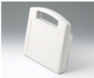
B4208107 CARRYTEC S ABS (UL 94 HB) grauweiß, RAL 9002 222x205x80mm IP 54 opt.
