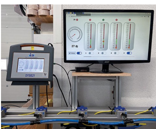
Überwachungssystem für Reinigungsdüsen
