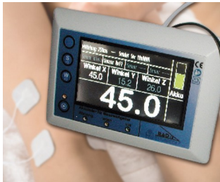
3D-Winkelmessung von Gelenksystemen auf Schwerkraftbasis
