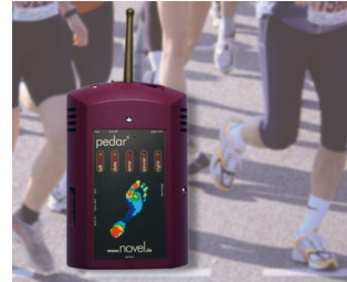
Dynamische Druckmessung zwischen Fuß und Schuh
