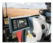
ISOBUS-Terminal für Traktoren und selbstfahrende Arbeitsmaschinen
