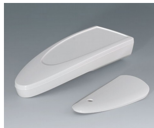
B2804017 STYLE-CASE L ASA (UL 94 HB) verkehrsweiß RAL 9016 166x64x31mm IP 65 opt., IP 40
