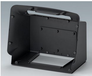
C3604708 COMMUNITEC M, Grundgehäuse ASA+PC (UL 94 V-0) anthrazitgrau RAL 7016 340x194x273mm IP 40
