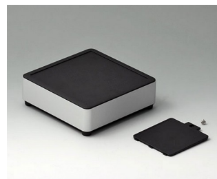
ES123059 SYNERGY S120 Aluminium AIMgSi 0,5 matt eloxiert 120x120x40mm IP 40
