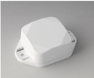
B1802227 MINI-DATA-BOX SF40, hoch, mit Flansch ASA+PC (UL 94 V-0) verkehrsweiß RAL 9016 40x40x20mm IP 65 opt., IP 40
