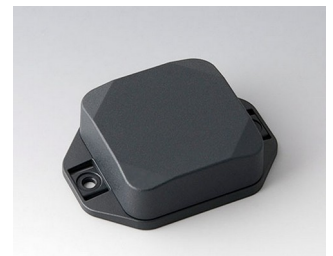
B1804228 MINI-DATA-BOX SF50, hoch, mit Flansch ASA+PC (UL 94 V-0) anthrazitgrau RAL 7016 50x50x20mm IP 65 opt., IP 40
