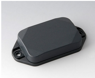
B1822128 MINI-DATA-BOX EF40, flach, mit Flansch ASA+PC (UL 94 V-0) anthrazitgrau RAL 7016 60x40x15mm IP 65 opt., IP 40
