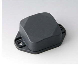
B1802228 MINI-DATA-BOX SF40, hoch, mit Flansch ASA+PC (UL 94 V-0) anthrazitgrau RAL 7016 40x40x20mm IP 65 opt., IP 40
