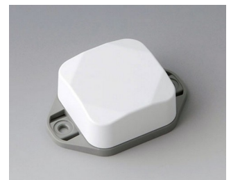
B1802226 MINI-DATA-BOX SF40, hoch, mit Flansch ASA+PC (UL 94 V-0) verkehrsweiß RAL 9016 40x40x20mm IP 65 opt., IP 40
