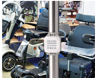
Datenlogger für den Fahrbetrieb
